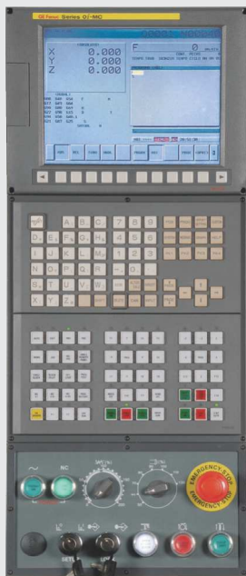
CNC Fanuc Oi-MD, aplicado no ROMI D 600, ROMI D 800, ROMI D 1000 e ROMI D 1250
