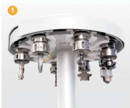
④ Magazine troca-ferramentas com 8 posições que se move na direção X
