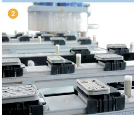
Segunda fileira de topos e 20 sapatas de vácuo standard são a base para os 4 campos de trabalho
