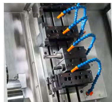
Sistema Gang Tools para suportes porta-ferramentas: inclinação 60°, facilidade de acesso do operador aos suportes de ferramentas e escoamento de cavacos
