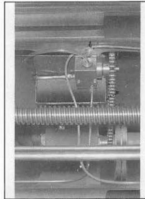
Bomba de lubrificação centralizada automática na base
