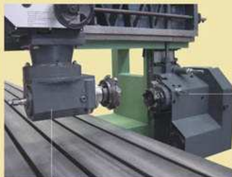
Opcional Sub-Cabeçote Usinagem a 90° Giro de 360°
