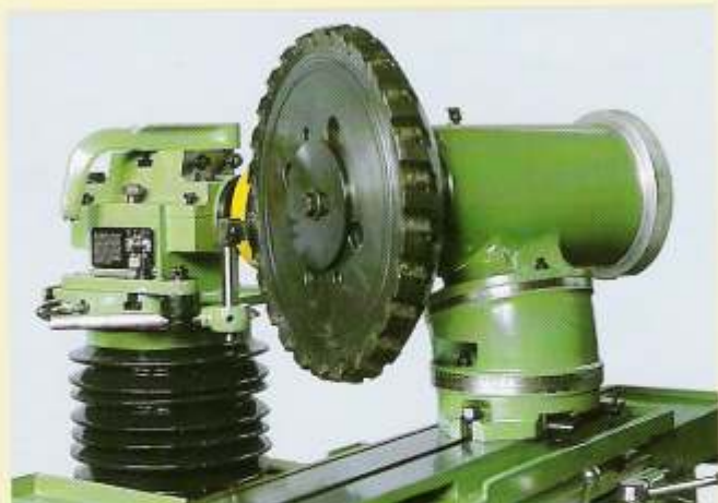
F51 - Aparelho para afiação de fresas de faceamento de grandes diâmetros.
