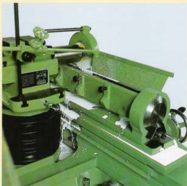
F18 - Exemplo de retificação plana tangencial com a afiadora AMX-15, com refrigeração, aparelho para retificar régua e equipamento hidráulico.
