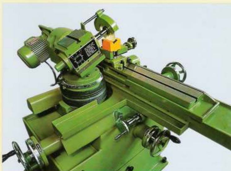
F16 - Exemplo de retificação de uma ferramenta de dobramento com a afiadora AMY-15.
