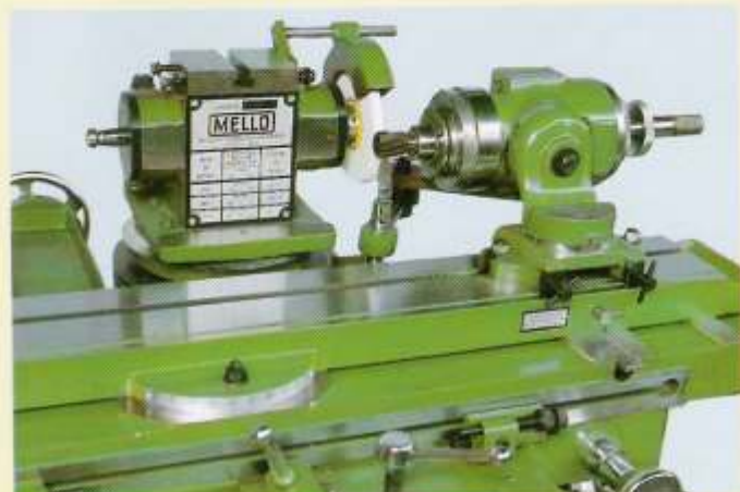
F57 - Aparelho para afiação de pequenas fresas de topo com haste.
