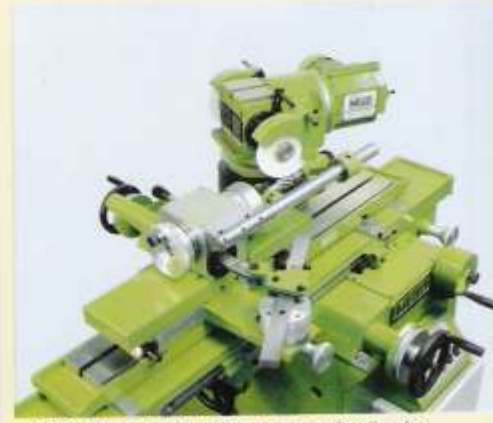
F70 - Gerador de hélices para afiação de ferramentas helicoidais, LITUUS.
