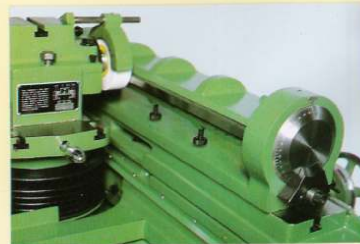
F55 - Aparelho para retificação de réguas e lâminas.
