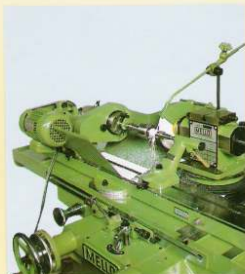
F12 - Exemplo de retificação cilíndrica com a afiadora AMX-15, com refrigeração, porta-peças de quatro velocidades e equipamento hidráulico.
