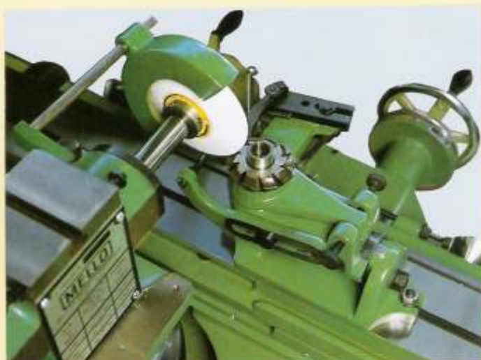
F52 - Aparelho para afiação de fresas de perfil constante.
