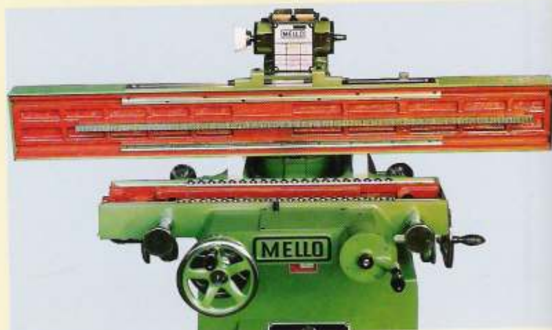
F24 - A mesa movimenta-se sobre esferas em guias temperadas.
