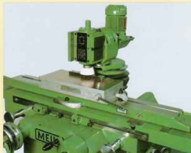
F17 - Exemplo de retificação plana frontal com a afiadora AMY-15.
