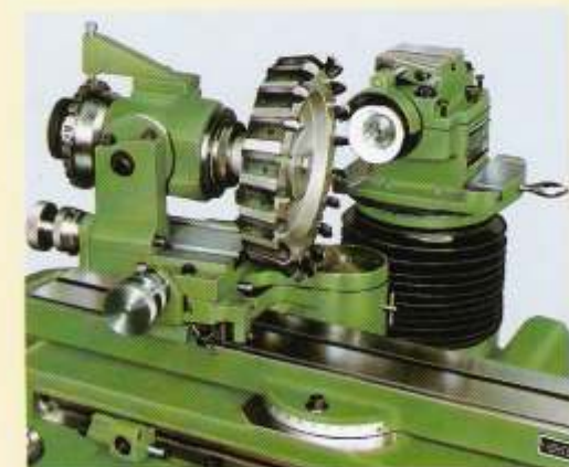
F68 - Aparelho nº 2 para afiação de raios em fresas e retificação de calotes esféricos.
