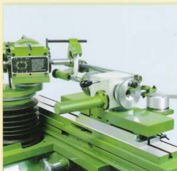
F19 - Afiadora AMY-15, com aparelho gerador de hélices, LITUUS.
