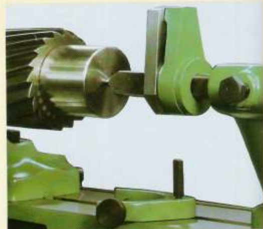
F11 - Contra-ponta esquerda com escala para o ângulo de incidência.
