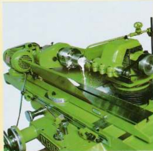
F13 - Exemplo de retificação interna com a afiadora AMX-15, com refrigeração, porta-peças de quatro velocidades e equipamento hidráulico.
