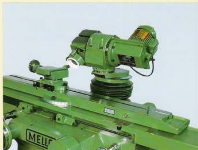
F15 - Exemplo de afiação de uma ferramenta monocortante com a afiadora AMY-15.
