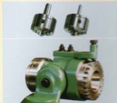
F76 - Placa universal de 3 castanhas. F77 - Aparelho divisor para o cabeçote porta-ferramentas.
