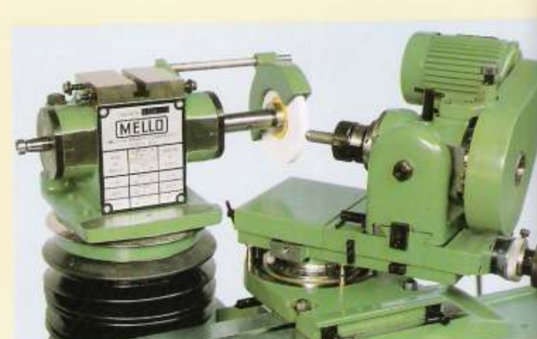
F67 - Aparelho nº 1 para afiação de raios em fresas e retificação de calotes esféricos.
