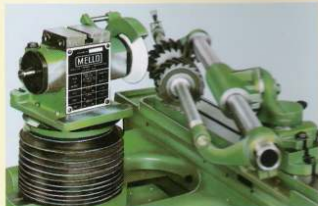
F72 - Aparelho para afiação de alargadores longos ou fresas montadas em eixos longos.
