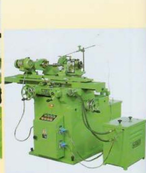
F14 - Afiadora AMX-15, com equipamento hidráulico, porta-peças de quatro velocidades e refrigeração.
