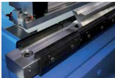
Bancada autocentrante com fixação inferior standard e aperto manual. Bancada auto-centrante con blocaje inferior de série y ajuste manual.
