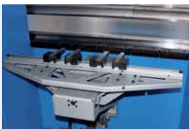
Mecânica Gasmec 2 eixos (X e R). Exclusiva para máquinas de 25 T. Mecánica Gasmec con 2 ejes (X y R). Exclusiva para máquinas de 25 T.
