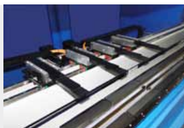
Mecânica Gasmec 4 eixos (X, R, Z1 e Z2), com deslocamento frontal e aperto pneumático dos topes. Exclusiva para linha G-BEND até 250 T. Mecánica Gasmec con 2 ejes (X, R, Z1 e Z2), con desplazamiento frontal y ajuste neumático de los topes. Exclusiva para la línea G-BEND hasta 250 T.
