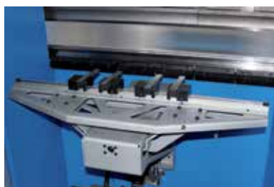
Mecânica Gasmec 2 eixos (X e R). Mecánica Gasmec con 2 ejes (X y R).
