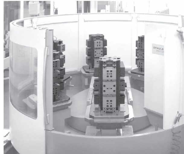
CUBOMORSA em um sistema de pallet a carrocél em um centro de usinagem
