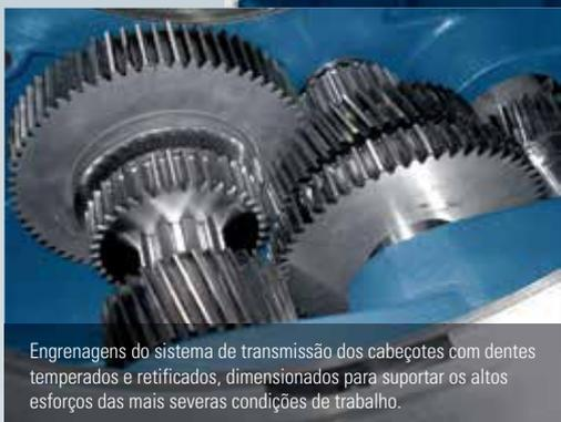
Engrenagens do sistema de transmissão dos cabeçotes com dentes temperados e retificados, dimensionados para suportar os altos esforços das mais severas condições de trabalho.
